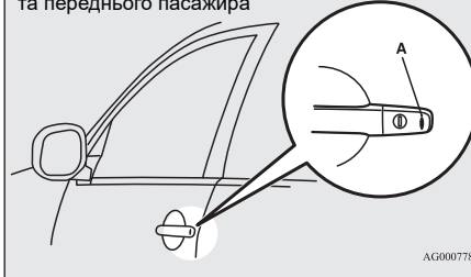
Кнопки замикання/відмикання на дверях водія та переднього пасажирського
