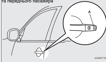
Кнопки замикання/відмикання на дверях водія та переднього пасажира
